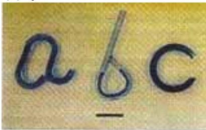
图 7 可自动弯曲成预定形状的智能凝胶
