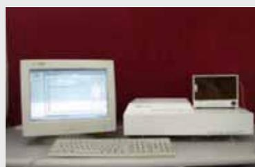
图 2、SPR-2000 型表面等离子体谐振生物传感器及分析仪照片
