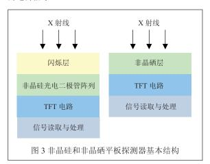
非晶硅平板探测器主要由闪烁层、非晶硅光敏二极管阵列、TFT 控制电路、读出控制电路和玻璃衬底等组成。闪烁荧光层主要是掺铊碘化铯针状(Csl:TI)晶体或掺铽硫氧化钆(Gd<sub>2</sub>O<sub>2</sub>S:Tb)陶瓷闪烁体,闪烁层的材料、工艺会影响探测器的量子探测效率(DQE)。非晶硅对放射线的伤害免疫,因此是理想的 X 射线接收材料 <sup>[2][15]</sup>。
