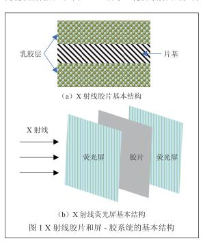
胶的卤化银微晶颗粒构成, X 光照射下, 卤化银分解产生潜影, 经过化学显影、定影等处理后得到了可视的 X 射线图像。 X 射线胶片对 X 射线吸收率非常低, 仅能达到 1% ~ 2%。 X 射线胶片的图像分辨率较好、保存时间长且价格低廉, 上世纪一直作为基本的 X 射线成像工具使用 [1][2], 但由于其 X 射线利用率非常低、无法实时成像等问题,已渐渐被其它成像手段取代。
