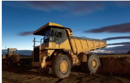
HDLS系列限位开关可以检测翻斗或货箱已完全就位或者没有在卡车底盘上。该信号会反馈给控制系统,从而为卡车操作员提供指示。
