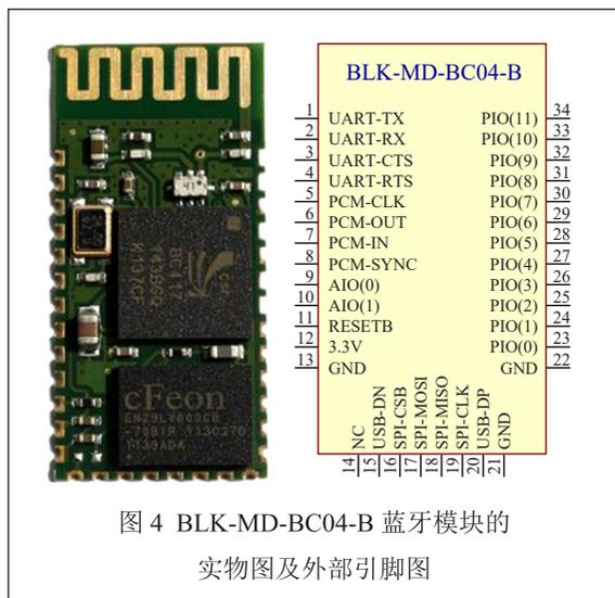
图 4 BLK-MD-BC04-B 蓝牙模块的实物图及外部引脚图
